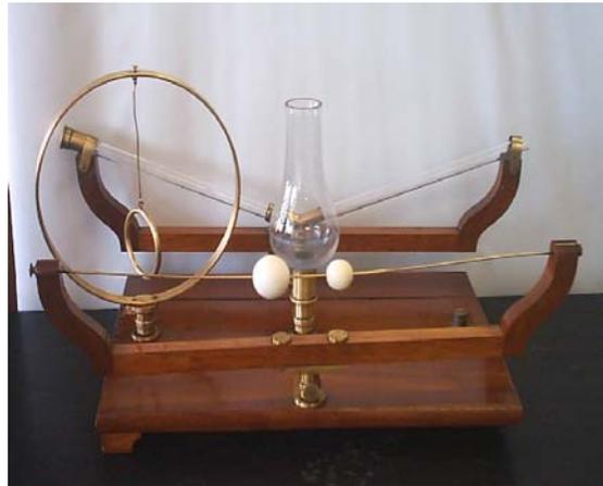
Lleva una base con los accesorios : dos bolas de distinto diámetro unidas por una cuerda, dos tubos de centrífuga , un recipiente de cristal destinado a mostrar el efecto de la fuerza centrífuga sobre los líquidos y un aro que lleva en su interior otro de menor diámetro que cuelga del mayor unido a él por un alambre. Al girar y alcanzar determinada velocidad de rotación el anillo más pequeño comienza a inclinarse hasta alcanzar una posición horizontal
