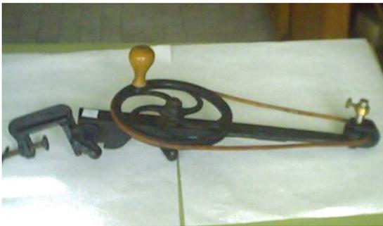
La máquina consta de una polea que se hace girar mediante una correa unida a una rueda con una manivela. En la polea se pueden colocar diferentes accesorios para demostrar distintas aplicaciones de la fuerza centrífuga como son:
