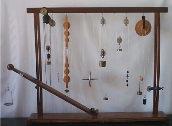
Consta de un marco de madera y una base de madera. De la parte superior se cuelgan distintos mecanismos, como poleas, polipastos etc. En la base tiene además un plano inclinado. Permite el estudio de diversos mecanismos y maquinas simples.
