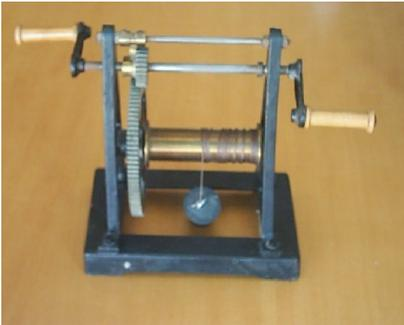
El torno de engranaje une a la vez la rueda dentada con un torno simple. Permite levantar una carga con comodidad debido a la razón de transmisión entre los engranajes
