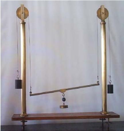
Este aparato sirve para estudiar la dirección de las fuerzas , así como para el estudio de la palanca, sustituyendo la polea central por una palanca de la que se cuelgan distintos pesos
